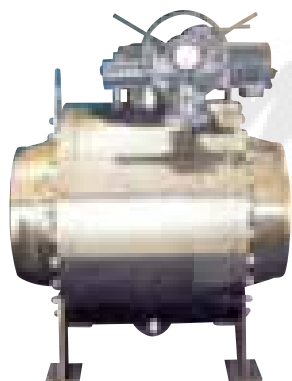
КМС API 6D шаровый кран (соединение на сварку), 50-1200 мм. Классы ANSI 150-2500.
