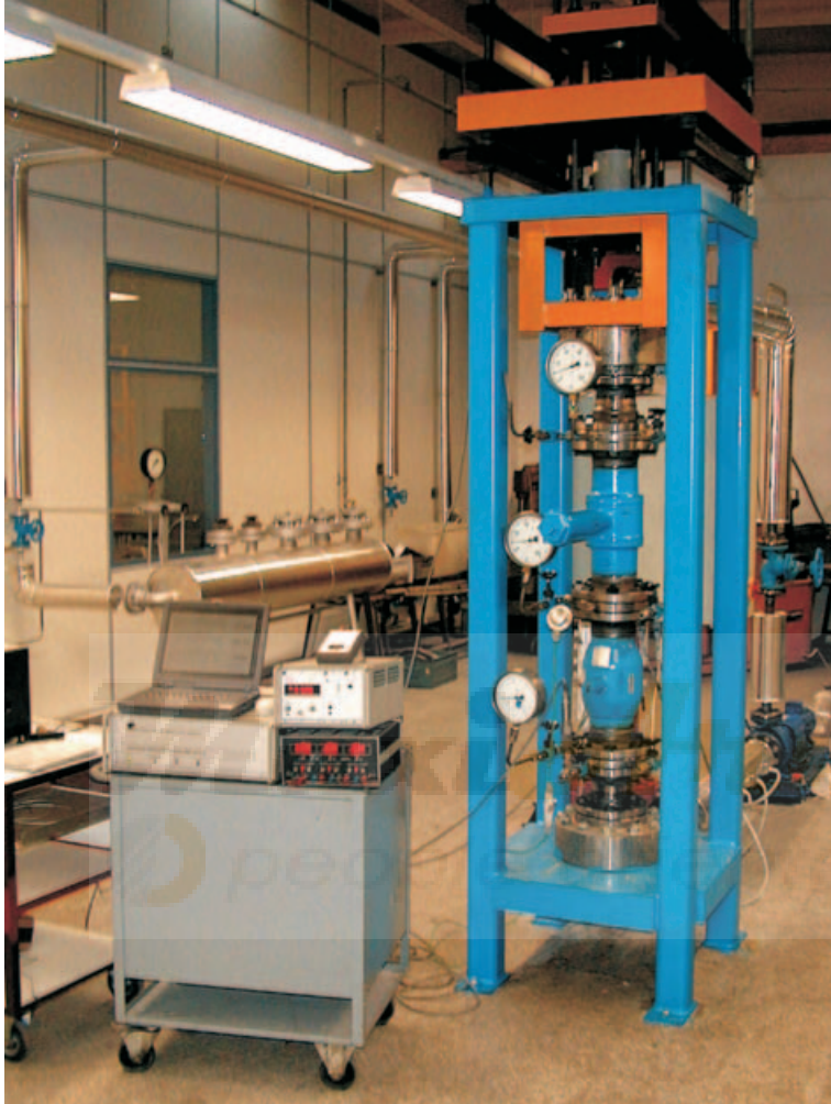
Испытательный стенд на прочность арматуры согласно EN 488 (трубопроводы для подземной прокладки).
