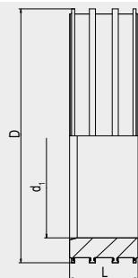
Соединительный элемент между готовым бетонным колодцем и FRIAFIT - вставной канализационной муфтой АЕМ. Широкие анкерные ребра с Т-профилем по всей поверхности изделия обеспечивают прочное и герметичное крепление в бетоне. Эластичная сердцевина для сглаживания напряжений. Большая толщина стенки для стабильности внутреннего диаметра. Надежное соединение с бетонной шахтой в соответствии с DIN V 4034.
