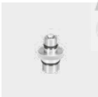
Используется для подключения манометра и компрессора с целью проведения испытания под давлением (опрессовки) через FRIALEN-арматуру для врезки под давлением типа DAA, DAP DAA-TL, DAA-TL/RE d1 = 63 - 315мм. (см. каталог FRIALEN). Присоединительная резьба = R 1/4".
