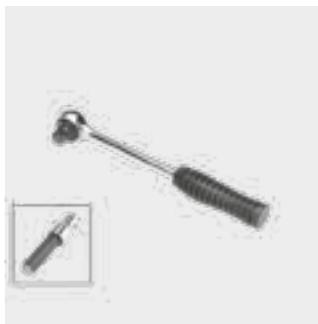
Используется в качестве операционного ключа для сверла-резака арматуры типа DAP (см. раздел FRIALEN), состоящего из храповой муфты (трещотки) 1/2" и насадки торцевого ключа.
