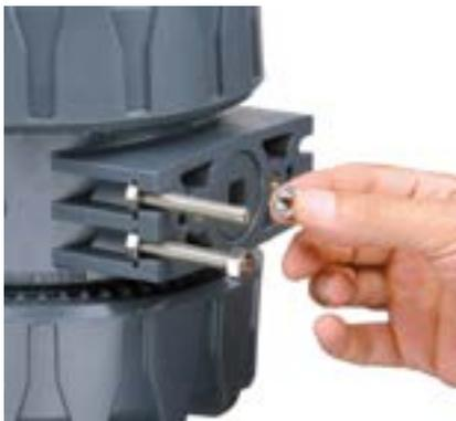
Во многих случаях краны любого типа как ручные, так и оснащенные приводом, требуют надлежащего крепления.
