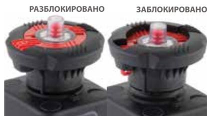
Клапан DK оснащен системой блокировки маховика DIALOCK®, препятствующей управлению клапаном. Эту систему можно активировать, подняв маховик после достижения нужного положения (рис. 8). Чтобы разблокировать управление, достаточно перевести маховик в первоначальное положение, нажав на него (рис. 6).
