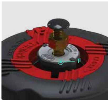
Мембранный клапан в исполнении DKL оснащен системой регулирования хода маховика, позволяющей установить максимальную и минимальную пропускную способность клапана и предупредить слишком сильное сжатие мембраны при закрытии.
