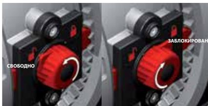
При повороте маховика фиксатора влево с ориентацией стрелки на изображение открытого замка устройство DUAL BLOCK® устанавливается в положение разблокировки: накидные гайки крана свободно вращаются по часовой стрелке и против часовой стрелки.
