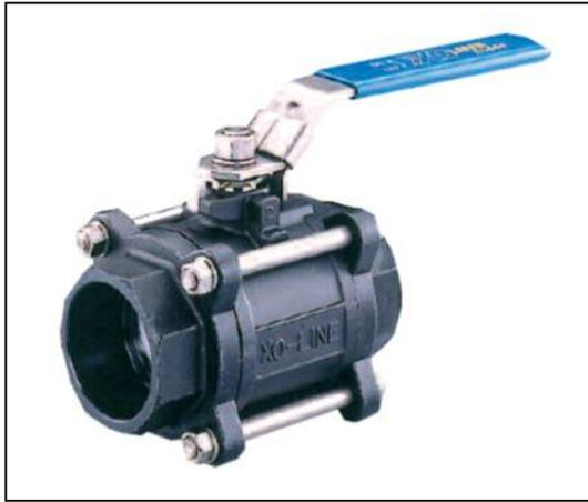
**Рис. 11.** Кран шаровой полнопроходной с раструбными патрубками под приварку типа Х3444S.
